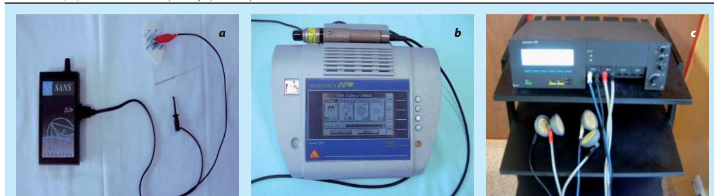
a) Stollerův neurostimulátor; b) biostimulační laser; c) multifunkční přístroj pro elektrostimulaci Phyaction
