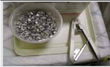
Obrázek 4. Kleště a svorky užívané k uzavěru odběrových vaků
